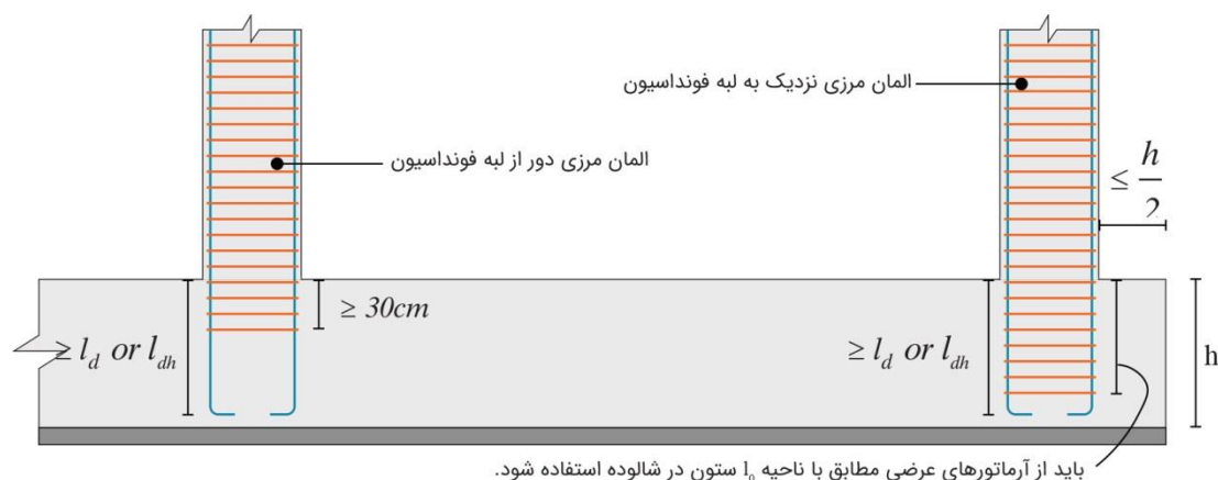
شکل ۸-۱۴: امتداد ناحیه مرزی دیوار برشی درون فونداسیون
